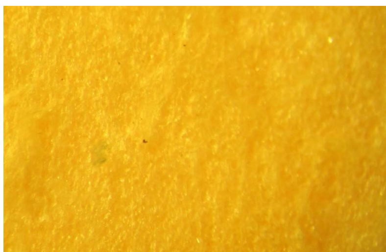
Рис. 7. Поверхность материала "Пеноплэкс", извлеченного из агрессивной жидкой среды после 3-х месяцев испытаний (присутствие биопленок и рост микроорганизмов на поверхности материала не отмечено).
